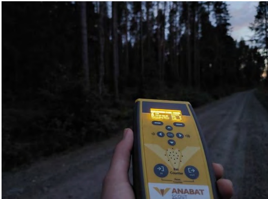
Kuva 4-1. Lepakkokartoituksessa käytetty Anabat scout -detektori havaitsee lepakkojen kaikuluotausääniä muuttaen ne ihmiskorvin kuultavaksi. Detektori kertoo automaattisesti havaitun äänen korkeuden kilohertseinä, minkä avulla voidaan tehdä lajimaaritus.
